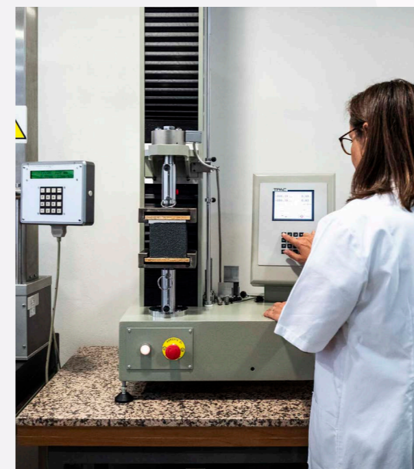
Il nostro laboratorio per il controllo della qualità: test per resistenza a trazione e compressione
